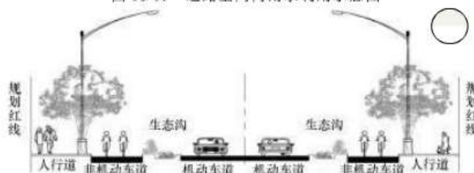
图 10-12 道路空间内生态沟设置横断面图
