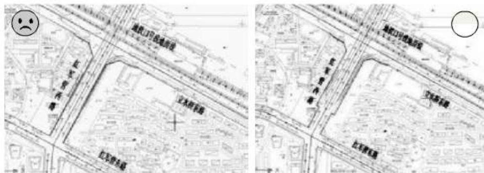
图 10-13 因下穿地铁 13 号线而局部拓宽道路红线的红军营西路
