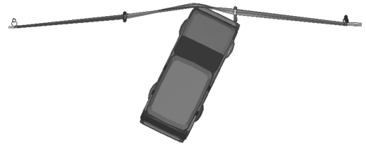
图 3 碰撞后 140ms 的护栏变形
