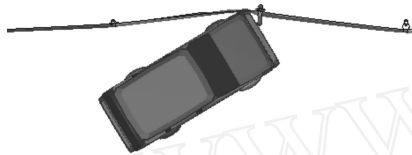
图 7 碰撞角 30°车速 50km/h 的仿真结果
