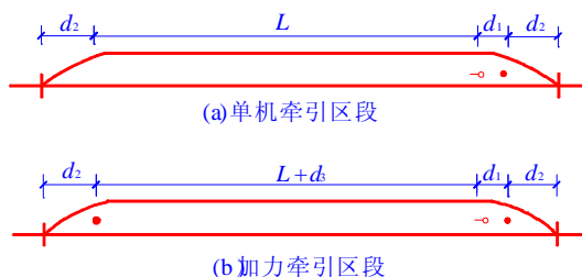
图 3.1.13 牵引机车与到发线有效长度关系图
