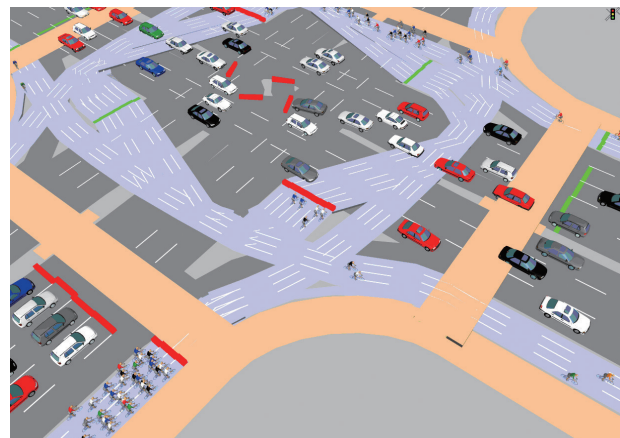
图8 混合路网干路交叉口交通渠化
