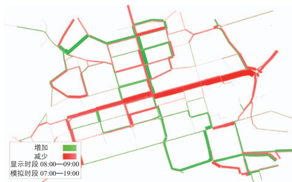
图9 爱丁堡中心区流量变化图 Fig.9 Central Edinburgh flow difference plot
