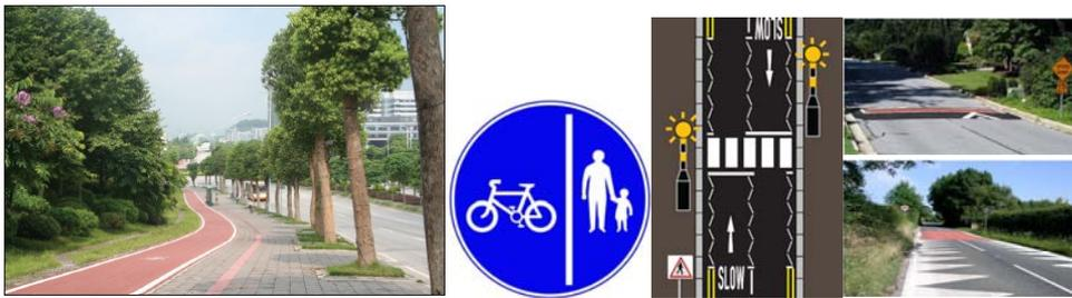
图6 慢行系统配套措施（彩色铺装、标识牌、安宁化设计示例）
