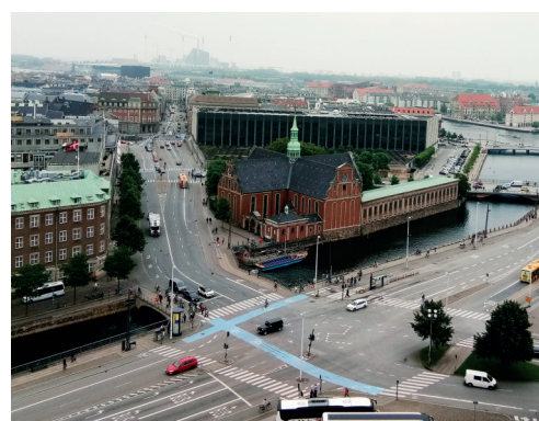
a 交叉口连续铺砌的彩色自行车道
