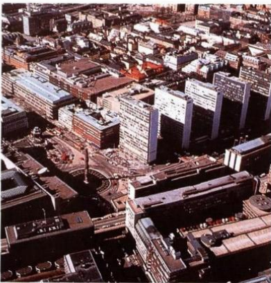
独立的高层大楼阻挡了高空猛烈的风并造成紊流。高层建筑周围的风力可以比其周边风力强4倍
