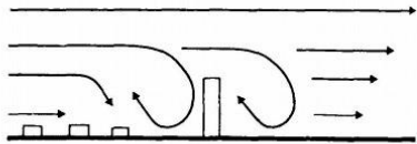
独立的高层大楼阻挡了高空猛烈的风并造成紊流。高层建筑周围的风力可以比其周边风力强4倍
